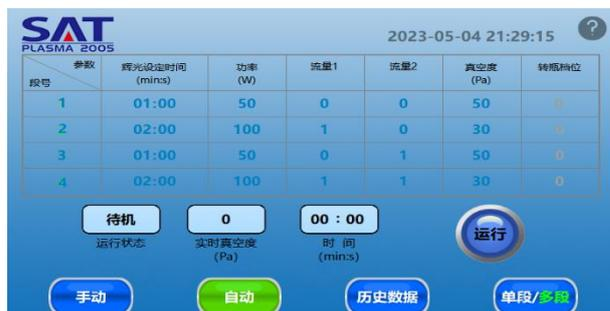
这个界面也是自动模下的一个工艺方式，在这个界面可以设置不同时间和功率，以及不同的气体，来进行多种气体不同时段和不同功率的情况下工作，主要应用于多种工作气体的使用。
