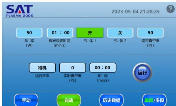
此界面可以设置功率(0—150W)、时间、气路开关状态、真空度值。设置时间要注意单位，前面是分钟，后半部分是秒。根据实验要求设置好工艺参数后，直接按运行按钮，设备会根据您设置的参数自动运行，并完成此工艺下的实验全过程。
